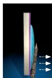
Wassertropfen setzen sich auf HT-veredelte Fliese und verbinden sich zu einem gleichmäßigen Wasserfilm, ...
